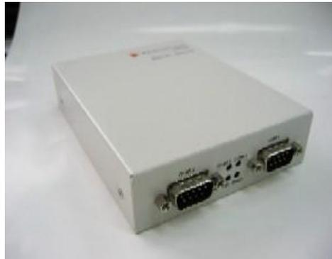
中新创科 DN 嵌入式串口服务器 / 客户机 / WEB 服务器提供给 OEM 客户一种非常简单、灵活的方式使他们的产品具备网络功能。DN 体积非常小，功耗很低，有 1 个或 2 个串行口，1 个 10M 以太网口，可以嵌入各种仪器、通信设备、测试仪表和数据采集设备中。客户可以使用 DN 的网络功能提供 Socket 连接、远程 telnet 登陆、web 服务和 SNMP 服务，支持多种 IP 地址和系统参数的设置方法。DN 有高效率的实时操作系统和健全的 TCP/IP 协议栈，大容量的输入输出缓存，高速的中央处理器保证数据传输的安全和准确。中新创科还可根据用户的要求设计 PCB，或增减其它功能服务。
